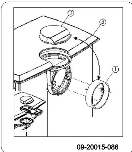
Het afsluitdekseltje (2) is zodanig ontworpen dat het, in geval van achteraansluiting integrerend deel lijkt uit te maken van de topplaat, en, bij topaansluiting, de achteruitgang kan afsluiten zonder storend zichtbaar te zijn.
